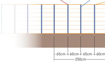
abgestuftes Abschlussgitter aus Doppelstabmaterial
