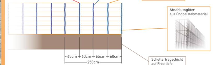
Die Fundamentierung hat nach statischer Erfordernis zu erfolgen. In der Regel ist eine Schottertragschicht auf Frosttiefe ausreichend. Nur in Ausnahmefällen ist ein Betonfundament notwendig.
