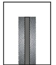
**Gründung:**  frostsicherer Unterbau (z.B. Mineralbeton, Kies 0/32)       Betonfundament
