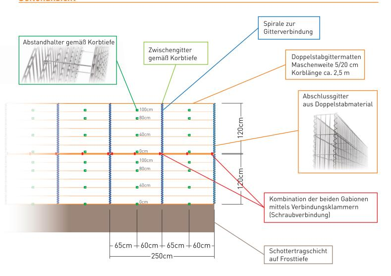
Die Fundamentierung hat nach statischer Erfordernis zu erfolgen. In der Regel ist eine Schottertragschicht auf Frosttiefe ausreichend. Nur in Außnahmefällen ist ein Betonfundament notwendig.
