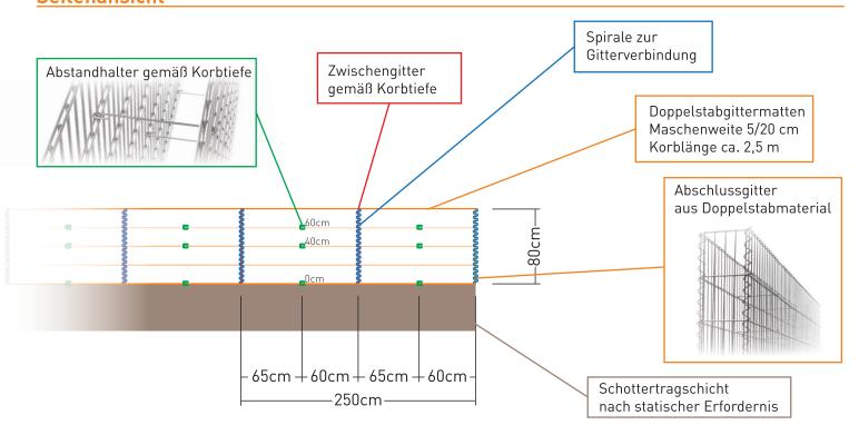
Die Fundamentierung hat nach statischer Erfordernis zu erfolgen. In der Regel ist eine Schottertragschicht auf Frosttiefe ausreichend. Nur in Außnahmefällen ist ein Betonfundament notwendig.
